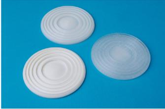
Рис.1. Фото монохроматических линз Френеля из разных термопластов (PLA, HIPS, COC)
