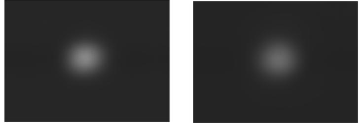
Рис. 4. Исходные изображения распределения интенсивности излучения, сфокусированного линзой Френеля (слева) и рефракционной линзой (справа).
