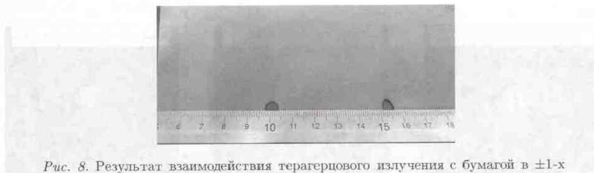
Рис. 8. Результат взаимодействия терагерцового излучения с бумагой в  $\pm 1$ -х дифракционных порядках делителя пучка
