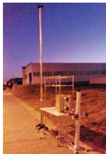
Рис.9. Бортовая установка SOLAR-T, соединенная с антенной системы Iridium в верхней части мачты Fig. 9. SOLAR-T "on-board" setup coupled to Iridium antenna at the top of the mast
