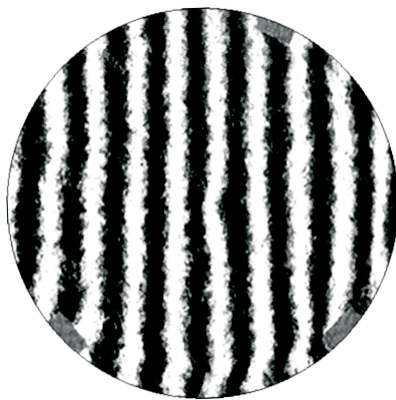
Рис. 2 Типичная интерферограмма внеосевого параболического зеркала.
