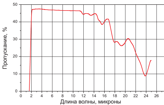
Рис. 2. Типичное пропускание германия оптического качества (толщина образца 2 мм).
